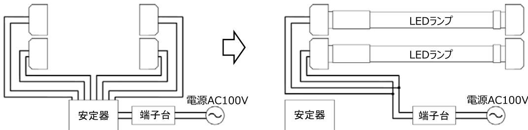
※本製品は、片側入力のAC直結電源接続に対応しています。
