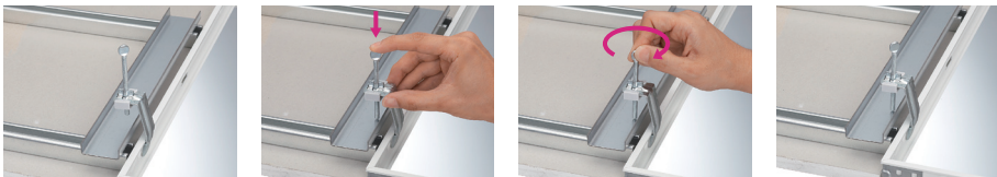
①ハンガーを外枠にセット ②ハンガーボルトを取付野縁に当たるところまで押し込む ③ハンガーボルトを数回回し締めつけ固定 ④完了
